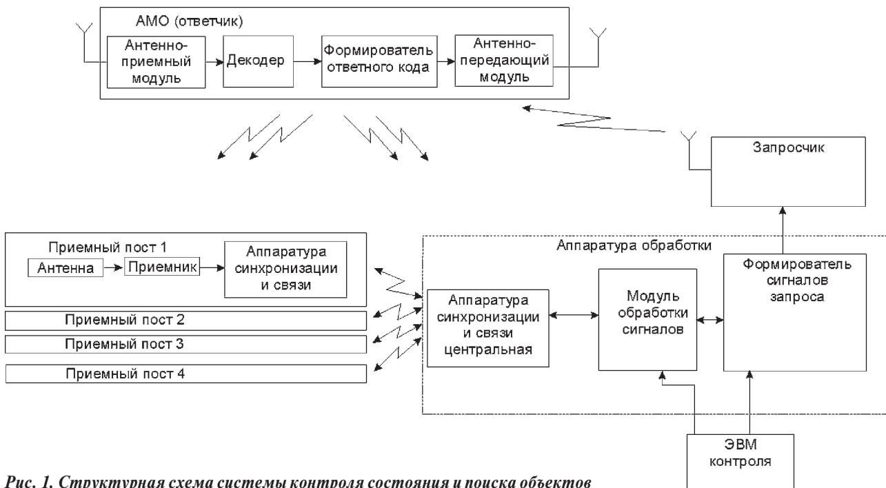
**Рис. 1. Структурная схема системы контроля состояния и поиска объектов**
