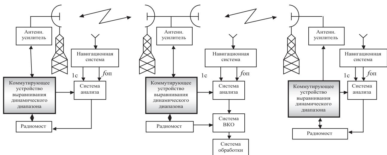
**Рис. 4. Структурная схема варианта построения системы синхронизации на базе спутниковой навигационной системы**
