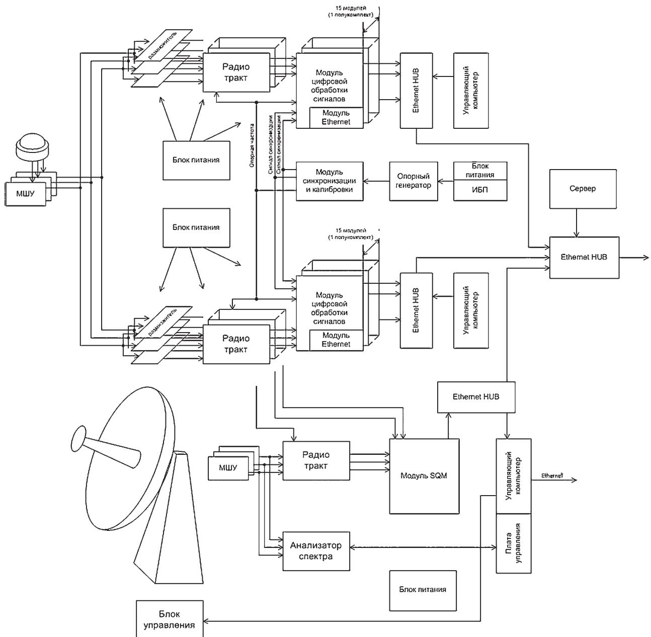
**Рис. 3. Стационарная АКНП. Структурная схема**
