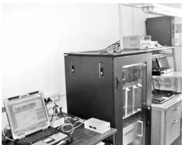
**Рис. 4. Стационарная АКНП. Евростойка в составе стенда**
