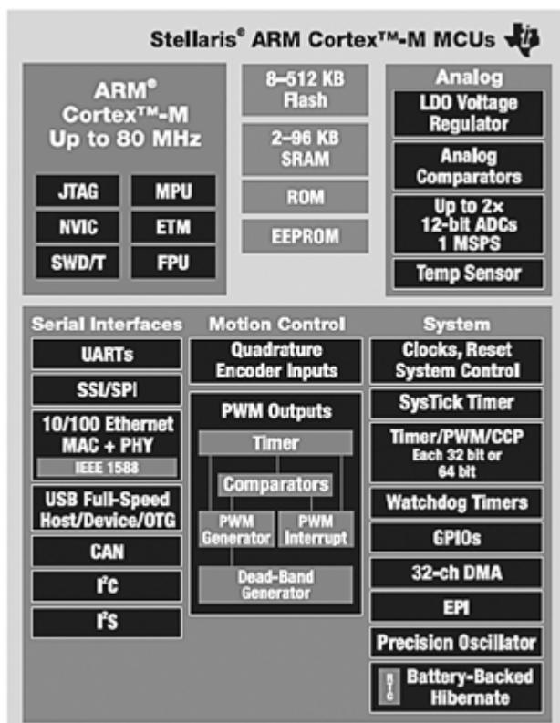
Рис. 3. Структурная схема процессоров семейства Stellaris
