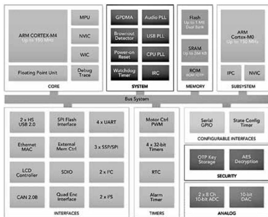
Рис. 7. Структурная схема сигнального контроллера LPC4300
