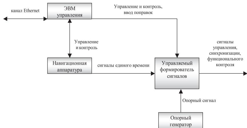
Рис. 2. Обобщенная структурная схема системы синхронизации и управления
