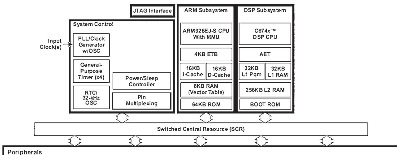
Рис. 5. Функциональная схема вычислительного ядра процессора OMAP-L132
