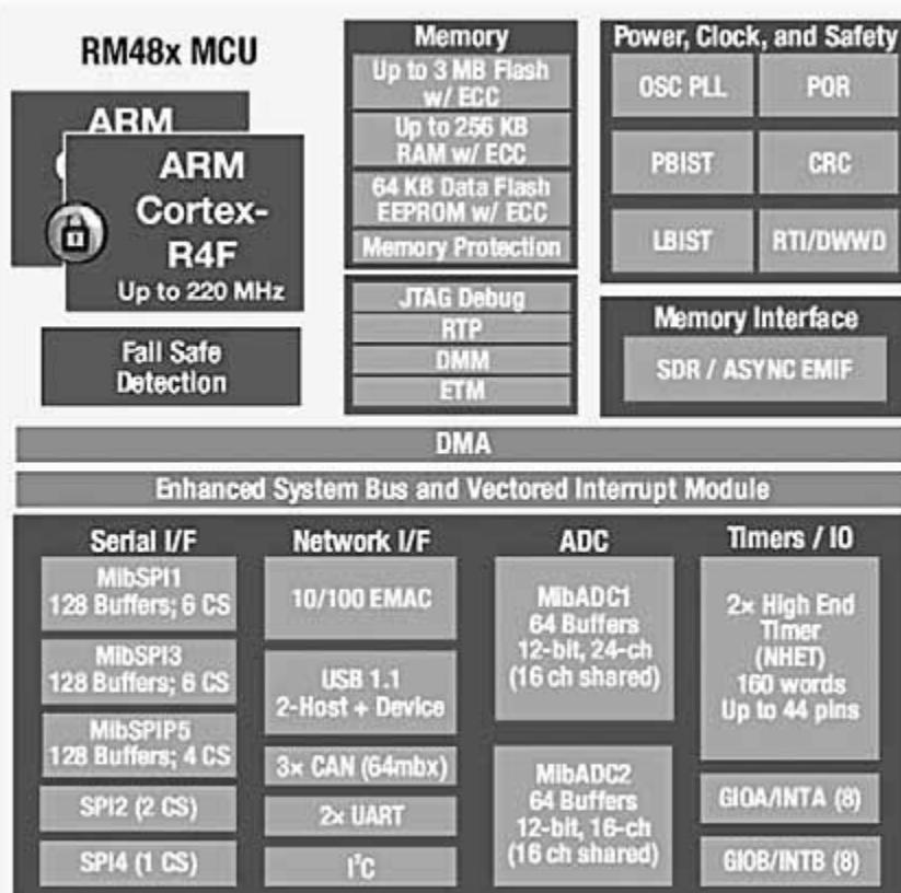
Рис. 6. Структурная схема микроконтроллеров RM48x семейства Hercules
